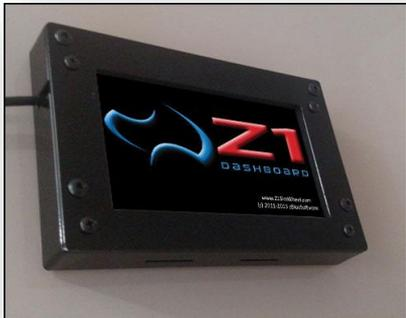
La pantalla LCD Z1 de Z1Bluesoftware se conecta a un puerto USB del ordenador en el que está corriendo el simulador. Cuando se utiliza esta pantalla, el software Z1 Dashboard detecta automáticamente la pantalla. La principal ventaja de esta pantalla es que utiliza menos tiempo de CPU, ya que parte del trabajo del dibujo lo realiza ella misma, en lugar del procesador del ordenador en el que corre el simulador.
