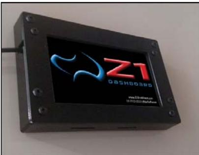
La pantalla LCD Z1 de Z1Bluesoftware se conecta a un puerto USB del ordenador en el que está corriendo el simulador. Cuando se utiliza esta pantalla, el software Z1 Dashboard detecta automáticamente la pantalla. La principal ventaja de esta pantalla es que utiliza menos tiempo de CPU, ya que parte del trabajo del dibujo lo realiza ella misma, en lugar del procesador del ordenador en el que corre el simulador. Consulte el manual original de Z1 Blue Software para disponer de más información.
